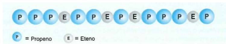
Figura 3. Representação da estrutura molecular do PP copolímero randômico (Adaptado da referência 9)
