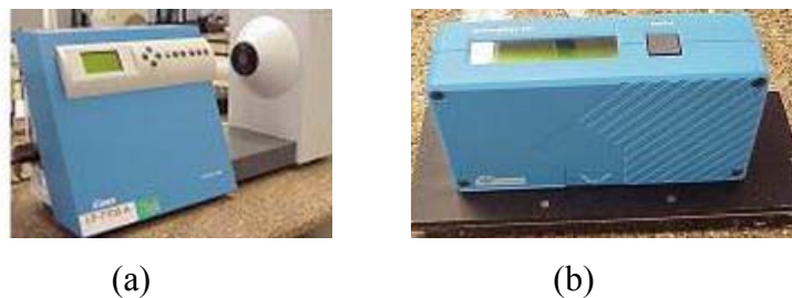
Figura 18. Fotografia dos equipamentos usados para medir (a) opacidade e (b) brilho
