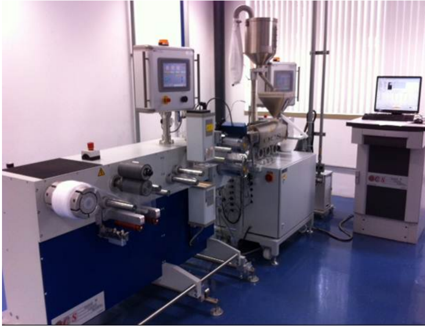
Figura 17. Fotografia da extrusora utilizada para medição de géis
