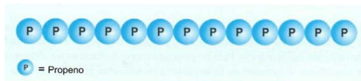
Figura 2. Representação da estrutura molecular do PP homopolímero (Adaptado da referência 9)
