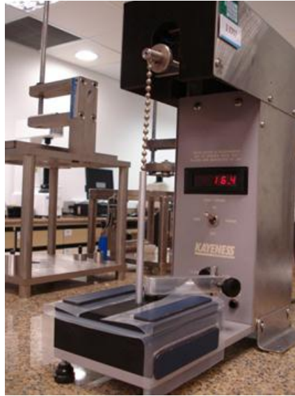
Figura 16. Fotografia do equipamento usado para medir bloqueio
