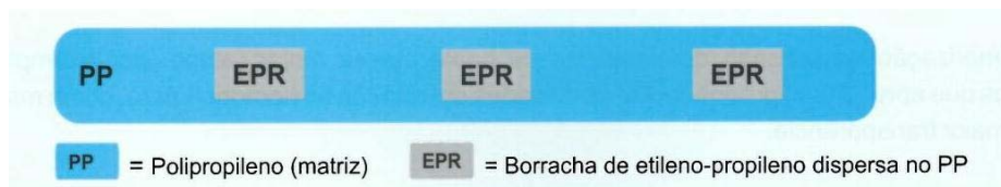
Figura 4. Representação da estrutura do PP copolímero heterofásico (Adaptado da referência 9)
