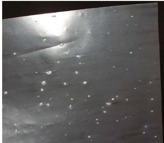
Figura 9. Fotografia de filme laminado com géis (Adaptado da referência 5)
