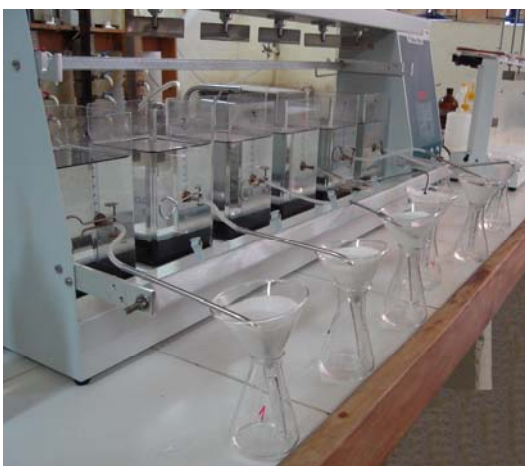
Figura 3. Seqüência de etapas do tratamento convencional simulada em equipamento de jarros. Etapa de filtração dos ensaios de adsorção.
