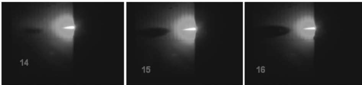
Figura 5. Imagens dos feixes de plasma para o primeiro experimento. A imagem “14” corresponde ao feixe de plasma formado com intensidade de corrente de 226,7 A, d.d.p. de 11,5 V, vazão do gás de 5 l/min e comprimento real do feixe de, aproximadamente, 12,5 mm; a imagem “15” corresponde ao feixe de plasma formado com intensidade de corrente de 213,3 A, d.d.p. de 14,6 V, vazão do gás de 10 l/min e comprimento real do feixe de, aproximadamente, 14,4 mm; a imagem “16” corresponde ao feixe de plasma formado com intensidade de corrente de 210,0 A, d.d.p. de 14,6 V, vazão do gás de 14 l/min e comprimento real do feixe de, aproximadamente, 13,0 mm.
