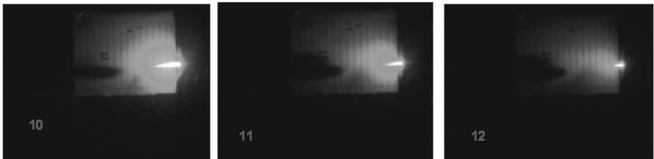
Figura 8. Imagens dos feixes de plasma para o segundo experimento. A imagem “10” corresponde ao feixe de plasma formado com intensidade de corrente de 206,7 A, d.d.p. de 17,7 V, vazão do gás de 14 l/min e comprimento real do feixe de, aproximadamente, 16,7 mm; a imagem “11” corresponde ao feixe de plasma formado com intensidade de corrente de 218,0 A, d.d.p. de 13,0 V, vazão do gás de 10 l/min e comprimento real do feixe de, aproximadamente, 8,9 mm; a imagem “12” corresponde ao feixe de plasma formado com intensidade de corrente de 221,3 A, d.d.p. de 11,7 V, vazão do gás de 5 l/min e comprimento real do feixe de, aproximadamente, 5,0 mm.
