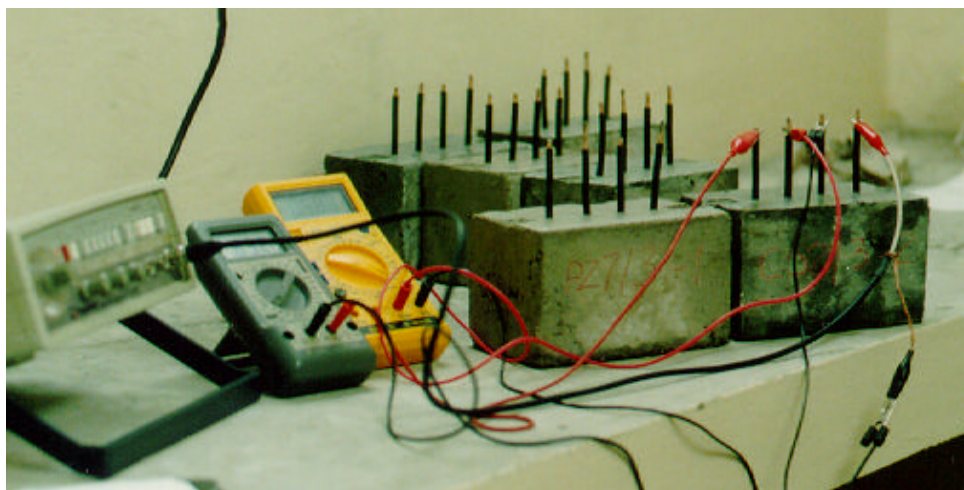
FIGURA 4.10 Ensaio de medida de resistividade elétrica aparente
