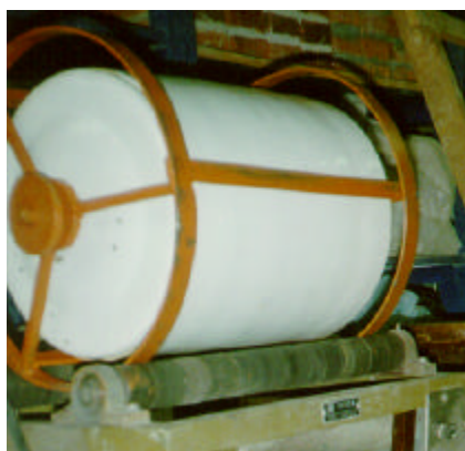
FIGURA 4.7 Moinho de bolas utilizado para moagem das cinzas de casca de arroz
